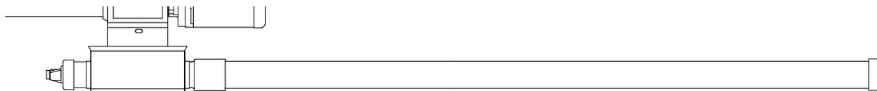
Установка удлиненной системы. Подвести удлиненную систему также, как стандартную систему в месте расположения контрольной единицы. Шнек нужно устанавливать соблюдая инструкции раздела «Установка шнека». Линию нужно развернуть на 90° влево или вправо с помощью насадки-накопителя.
