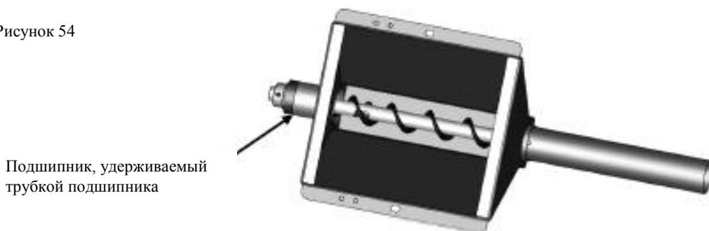
11. Переместите держатель подшипника и крышку подшипника на конец вала анкерной опоры, скобы и подвесного кронштейна. Теперь шнек полностью установлен.
