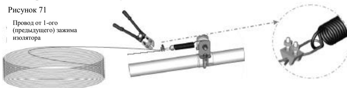
6. Теперь необходимо начать следующий шаг (50 футов) установки провода антинаесстной системы путем присоединения провода к тому же изолятору, к которому присоединена пружина. Для получения лучшего результата сделайте двойную петлю вокруг изолятора антинаесстной системы в центральной выемке изолятора и закрепите кабельным зажимом  $\frac{1}{16}$ ", как было сделано с бункером.
