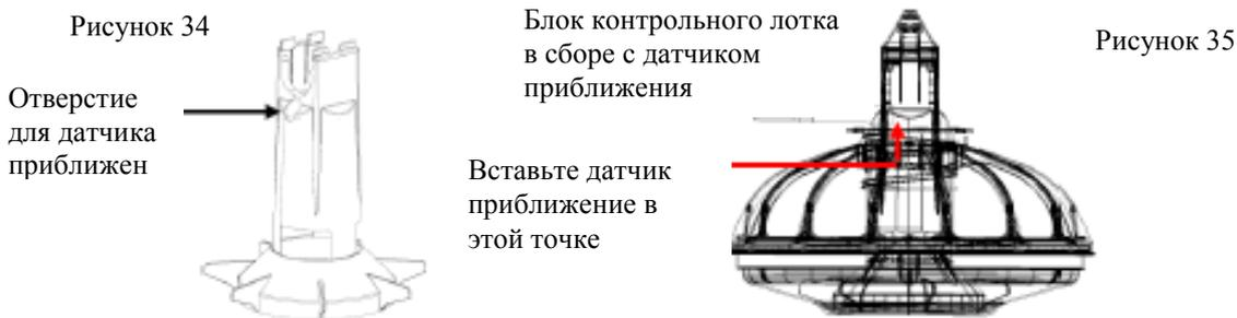
4. Прикрепите блок контрольного лотка к загрузочной трубе, при этом отверстия выгрузки корма должны быть направлены вниз по направлению к башне, и крышка башни должна быть установлена на башне, как в кормораздатчиках Fuze. (см. страницу 22 для более подробной информации).
