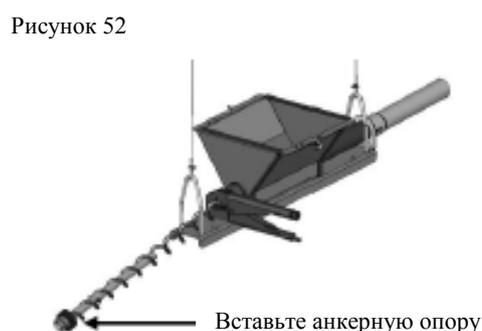
9. Поверните вал анкерной опоры в сборе, чтобы шнек мог двигаться между 2 роликовыми штифтами и достигать опорной шайбы на конце вала, как показано на рисунке 53 ниже. Когда шнек на месте, винт с головкой с углублением под ключ необходимо затянуть, чтобы зафиксировать шнек. Это надежно удержит шнек на одной стороне вала.
