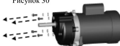
3. Удалите #010643 болты с шестигранной головкой 5/16 x 3/4, @010252 разъемные стопорные шайбы 5/16 и #010426 плоские шайбы 5/16 x 11/16, как показано на правом рисунке 30 выше, и используйте для крепления узла приводной головки и редуктора к загрузочной трубе в сборе на опорную плиту, как показано на левом рисунке 31 внизу.
