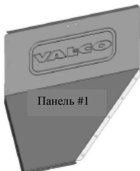
1. Соедините верхнюю загнутую кромку панели #2 с верхним краем панели #1 и закрепите с помощью #010615 болта с шестигранной головкой 1/4"-20% x 1/2", #010251 стопорных шайб 1/4" и #010602 шестигранной гайки 1/4".
